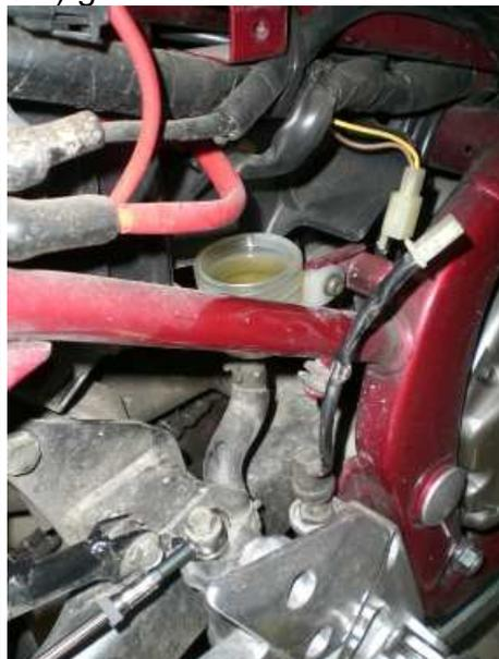
Nachdem ich mit der Spritze wieder Bremsflüssigkeit über die Entlüftungsnippel ins System gesogen hatte, musste ich das so lange weiter machen, bis nur noch neue Flüssigkeit aus den Nippeln kam, damit das Ganze alte Zeugs raus kam. Zwischendurch natürlich immer wieder den Behälter füllen, damit keine Luft ins System gesaugt wird. Falls dies doch mal passieren sollte, muss man noch mal so lange saugen, bis die Luft, die man reingesaugt hat, wieder raus ist.
