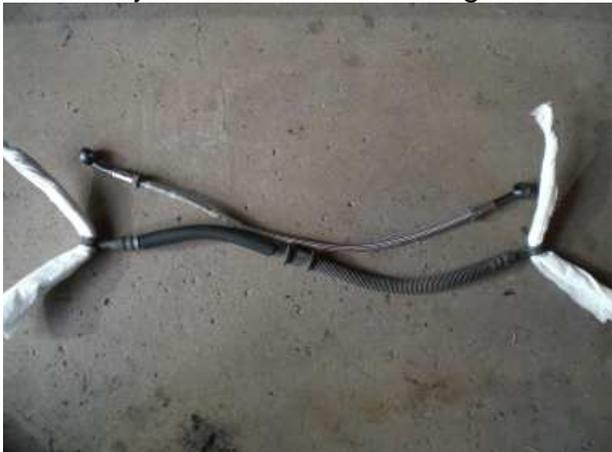
Danach wurde die neue Bremsleitung angebracht und festgeschraubt und der Ausgleichsbehälter mit frischem Saft (DOT 5.1) gefüllt.
